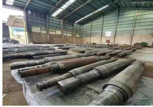
答：体积较大或尺寸较长的辊道、铁轨、钢筋、铸铁块等原料，需要经过加工处理，并且用于回炉冶炼，规格要符合标准要求：长度 $\leq 1500\text{mm}$ ；单重 $\leq 1500\text{kg}$ 。
