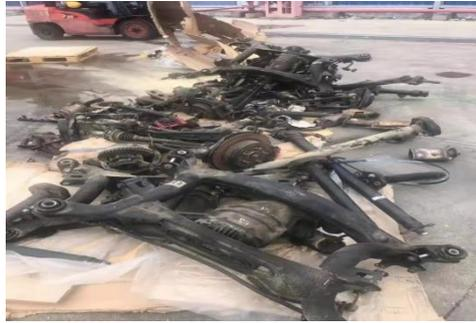
答：汽车拆解件、船舶拆解件等类别的原料，需要经过拆解、分类、加工处理，并对夹杂物、危险废物进行处理，将有色金属材料进行分选，才能使该类材料符合再生钢铁原料的标准要求。
